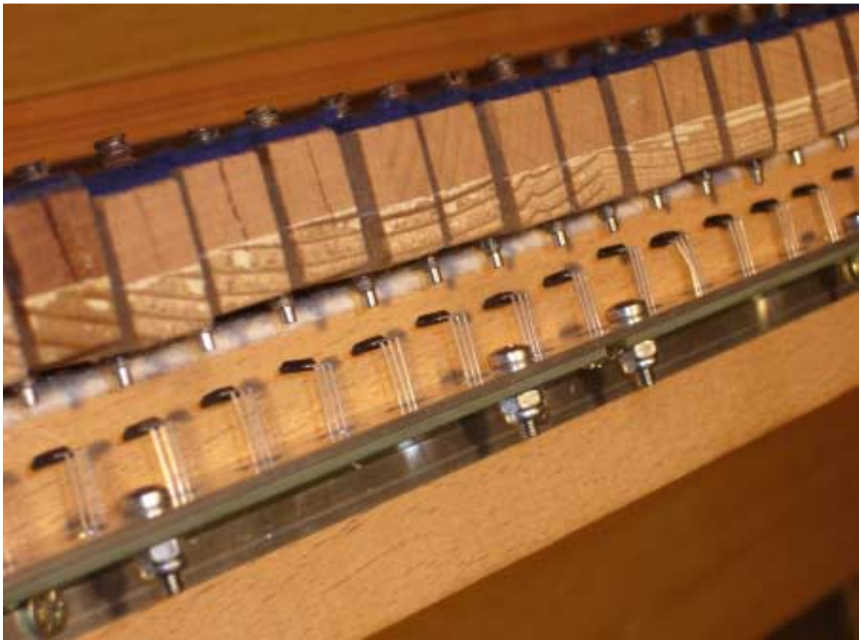
Hier ist die Schiene an der Klaviatur montiert. Die Magnete sind auf eine Distanz von ca. 5 mm vorjustiert.
